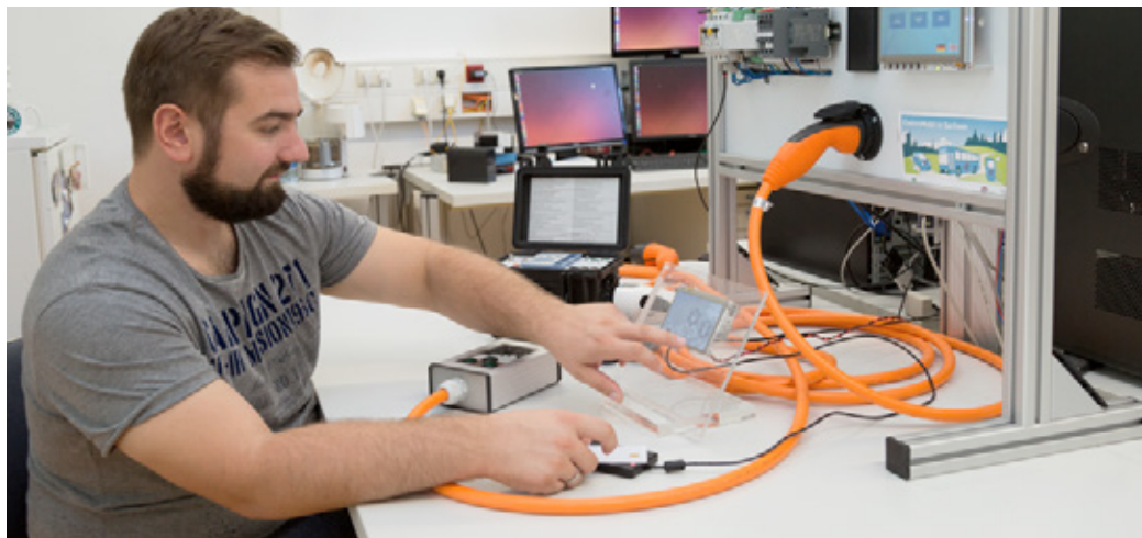
Im Elektrotechnik-Labor der HTWK Leipzig wurde das Innenleben der Lade-Laternen entwickelt. Im Bild testet Projektmitarbeiter Martin Leutelt die Anmeldung an der Ladestation.
